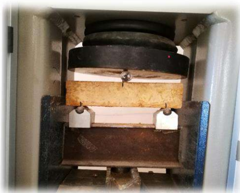
Photo N°6 : Essai de flexion
