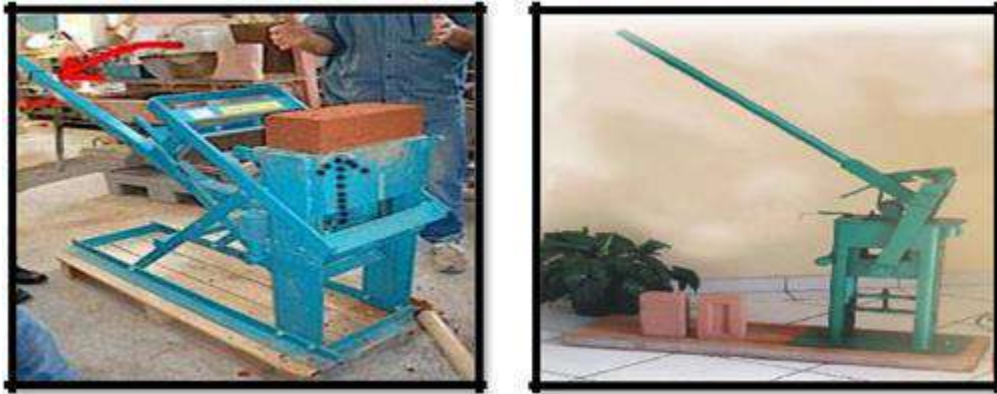
Figure I.8 ; I.9: Brique de terre crue compressée par une presse manuelle.
