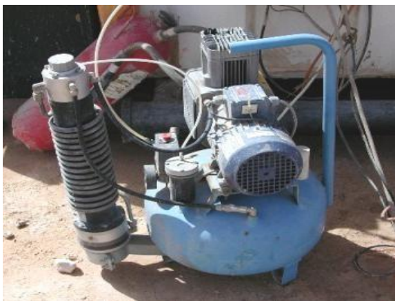
Figure II.6: Compresseur à air.
