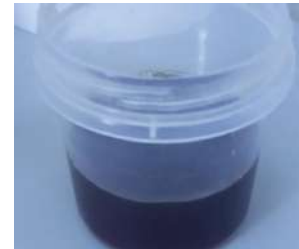
Sirop de datte (Evaporation sous vide à 65 C 0 )
