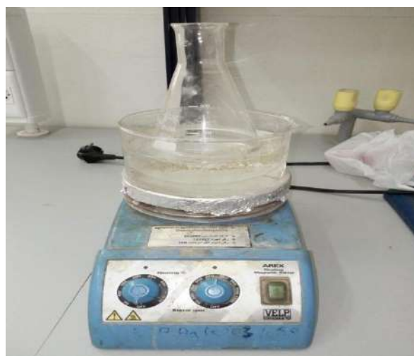
Photo 2 : Agitation de la solution dans la zéolite
