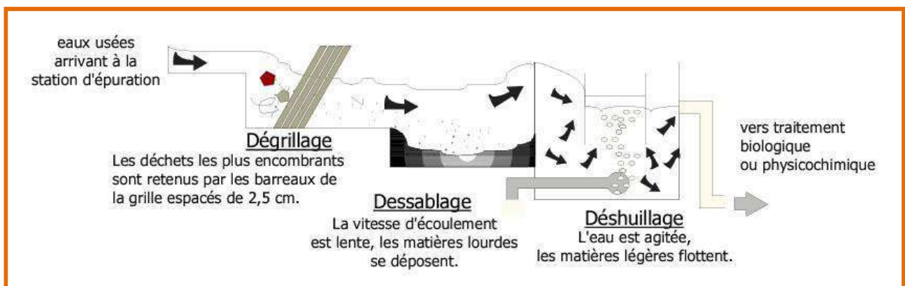
Figure 1 : Schéma représentatif des étapes de prétraitement
