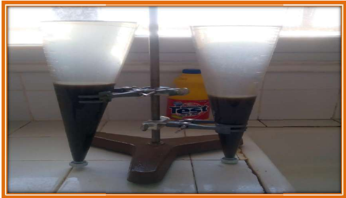
Figure 17 : Montage de mesure du volume des boues
