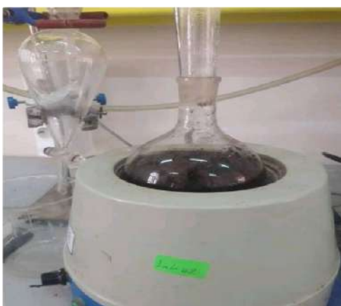
الصورة 05: عملية استخلاص الزيت
