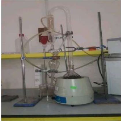
الصورة 02: جهاز التقطير المائي
