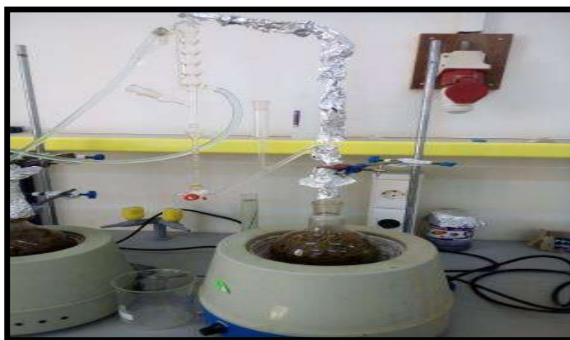
Figure .III.3: Montage expérimental de l'hydrodistillation.
