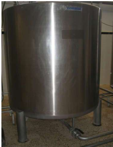
Figure 9 : Cuve de stockage de produit fini (lait).
