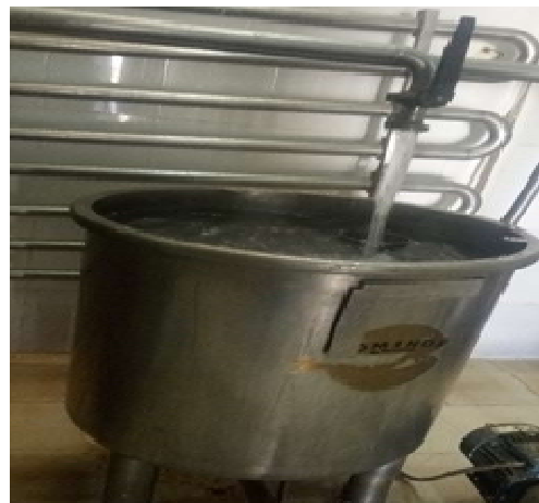
Cuve de nettoyage
