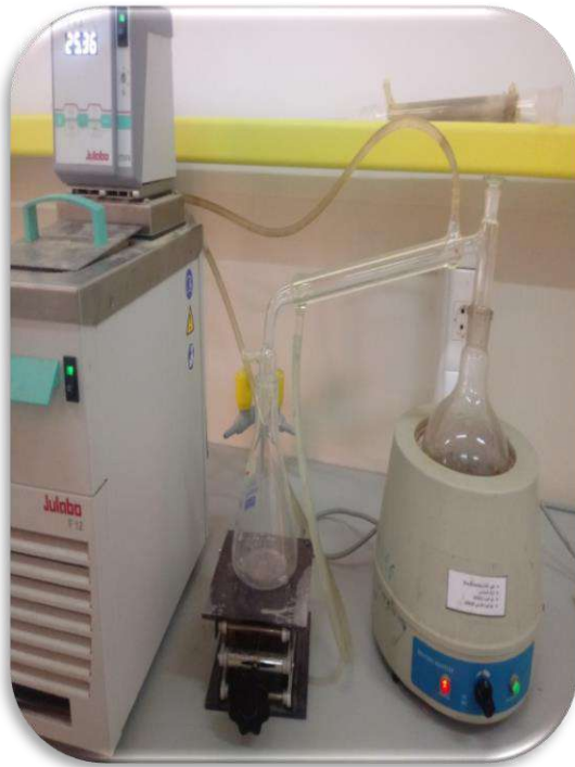
Figure III.9 : Distillation simple de bioéthanol.
