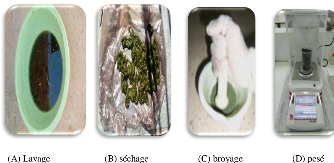
Figure III. 04 : Les étapes de la préparation de la biomasse.
