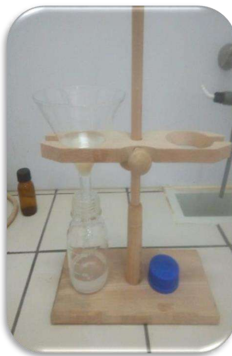
(B) filtration de bioéthanol séché
