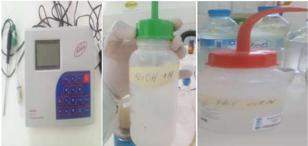
**Image 14 : Ajustement des valeurs de pH par NaOH et HCl aux valeurs requises**
