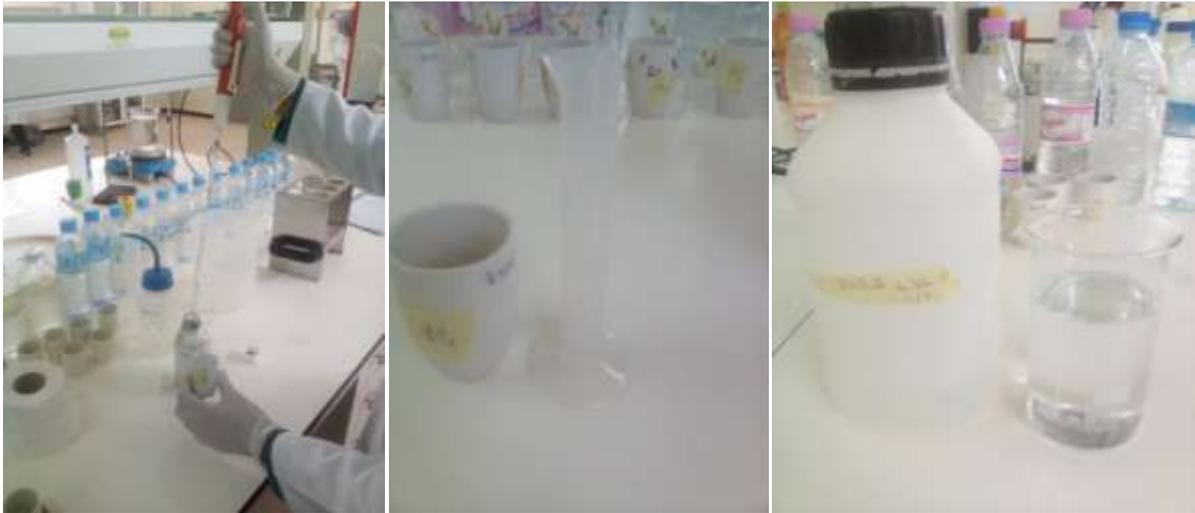
**Image 22 :Ajout de d'acide sulfurique, l'eau distillée et la solution d'hydroxyde de sodium et de tartrate double de sodium et de potassium**
