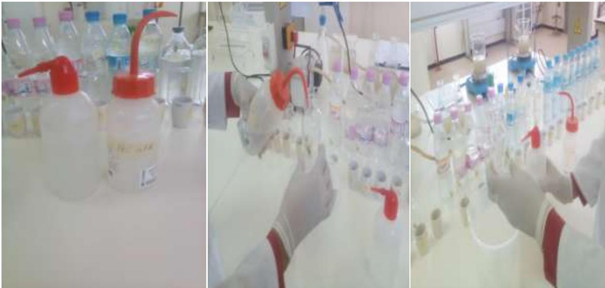
**Image 26: le lavage des Bouteilles avec de Hcl 0.1 N puis par l'eau distillée**
