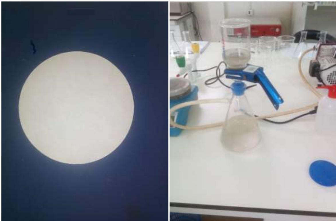
**Image 13 : Infiltration à l'aide d'une pompe à vide**
