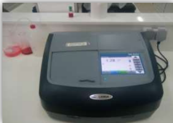
صورة 10. جهاز قياس تركيز الفليورايد "Spectrophotomètre, type DR6000"
