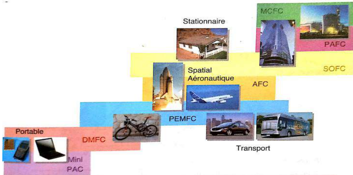
Figure III-10 : applications des piles à combustible par types de piles. [22]
