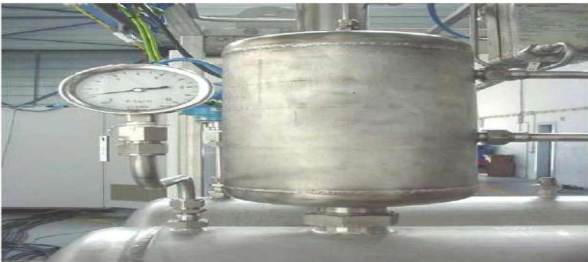
Figure II-8 : épurateur de gaz (rincer).
