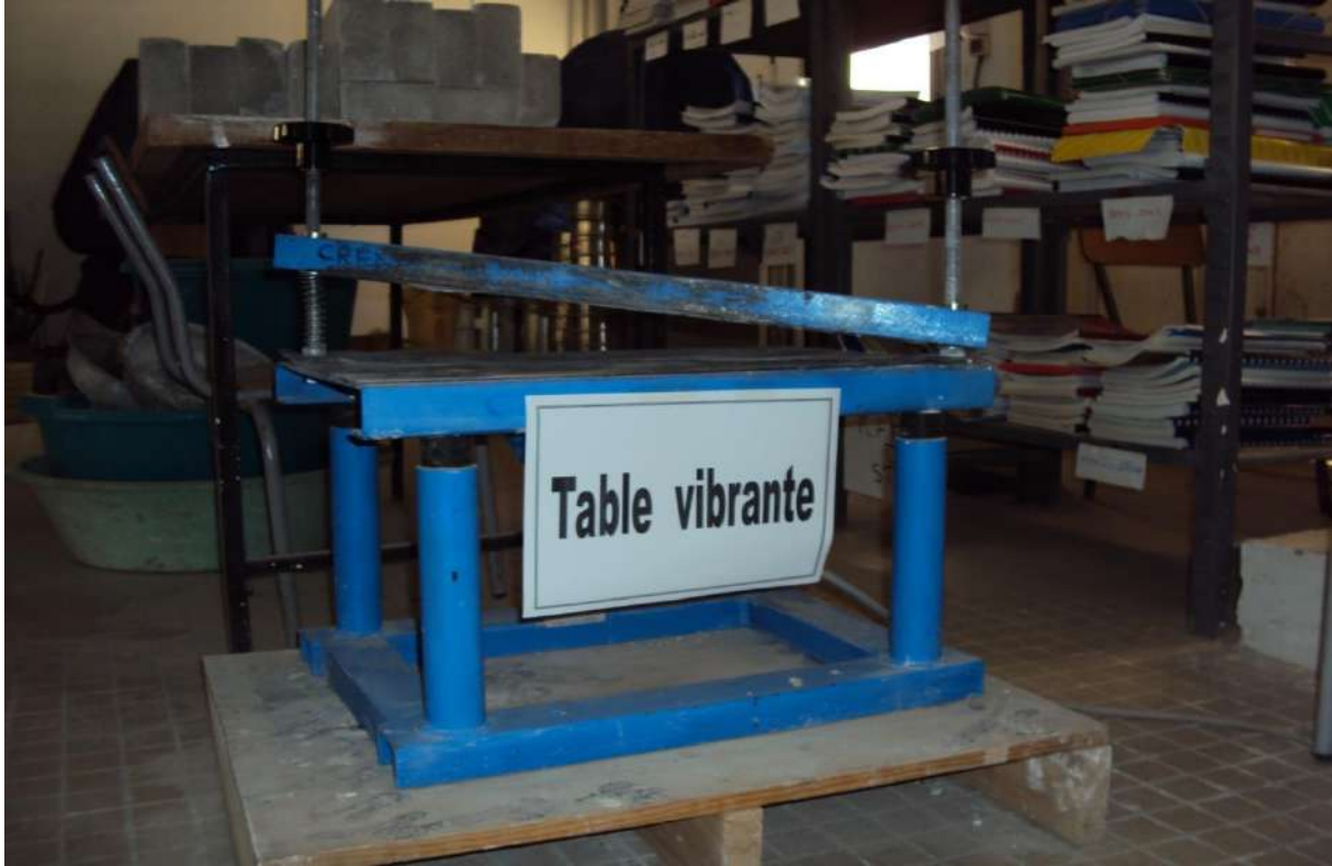
الصورة توضح الطاولة التي تم بها الهز في مخبر جامعة ورقلة.
