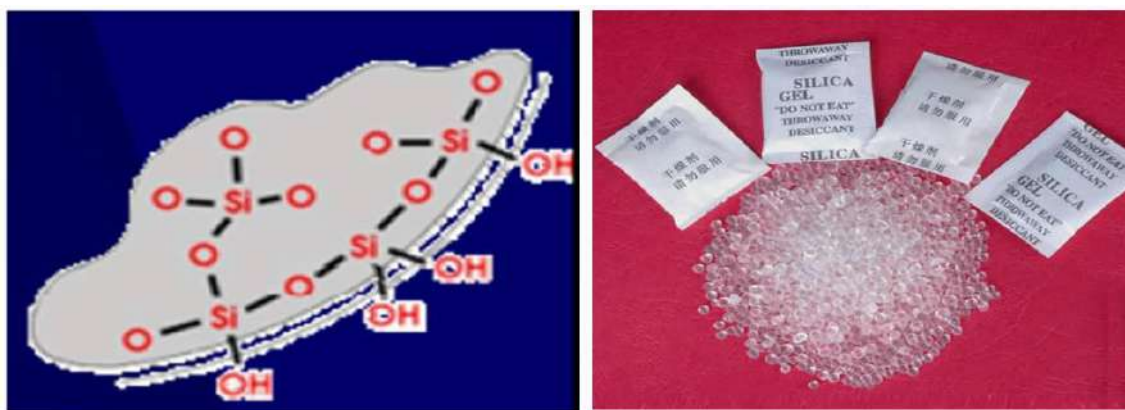
Figure II-5: Gels de silice schématisés, en vrac et conditionnés en sachets a) pour le schéma chimique et b) pour l'emballage en sachets [36].
