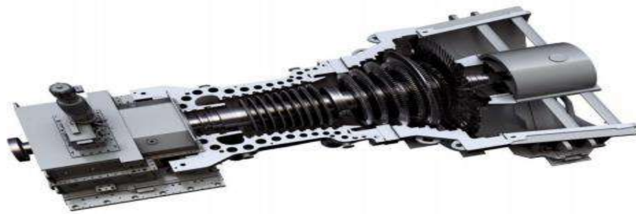
Figure(II , 8):turbine à vapeur
