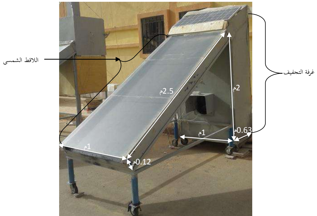
الشكل (4.IV): صورة المجفف الشمسي المستعمل توضح أبعاده وأجزائه الرئيسية
