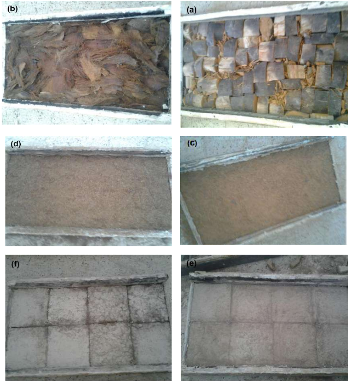
الشكل (11.111): صور النماذج التجريبية لعزل اللاقط الشمسي باستعمال الياف وخشب النخيل [Nadir et al., 2019].
