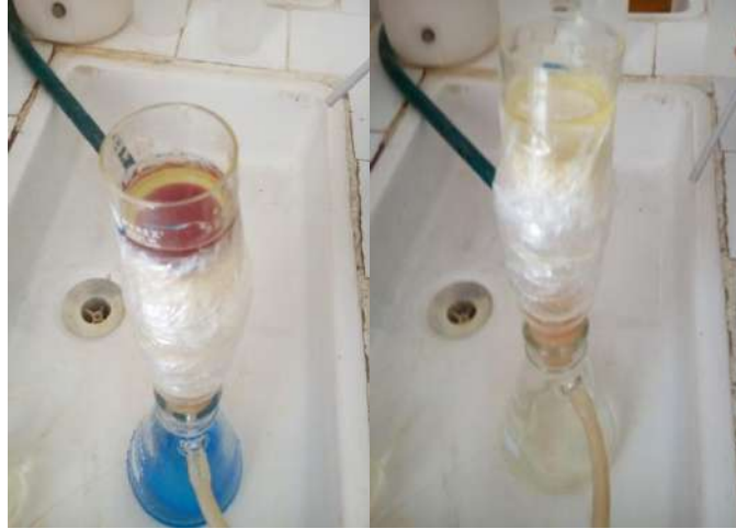
الشكل (53.IV): ترشيح راسب أكسيد النحاس.
