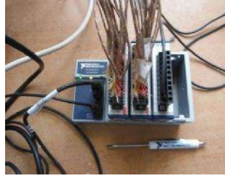
الشكل (6.IV): أجهزة قياس الحرارة 'Thermocouples' متصلة بجهاز حفظ المعلومات NI cDAQ-9174
