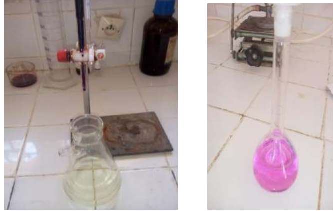
الشكل (54.IV): معايرة الحديد ( Fe^{+2} ) المتشكل بواسطة برمنغنات البوتاسيوم ( KMnO_4 )
