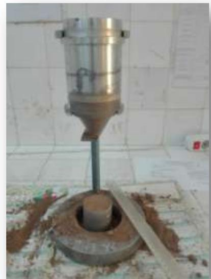
**Photo II- 2:** Essai la masse volumique apparente. 15
