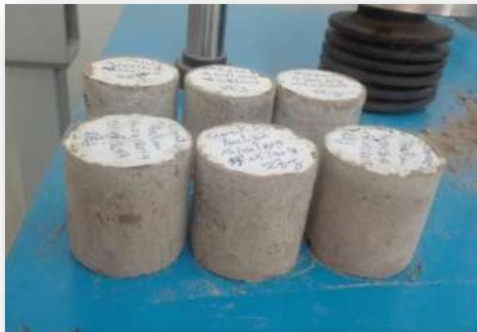
**Photo III- 3:** Les échantillons préparés pour l'essai de traction par fendage.
