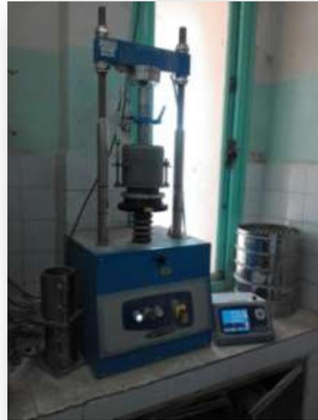
**Photo II- 5:** appareille d'essai CBR;
