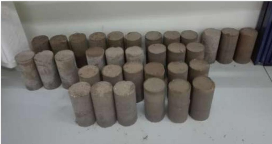
**Photo III- 1:** Les éprouvettes préparées pour l'essai de compression simple.
