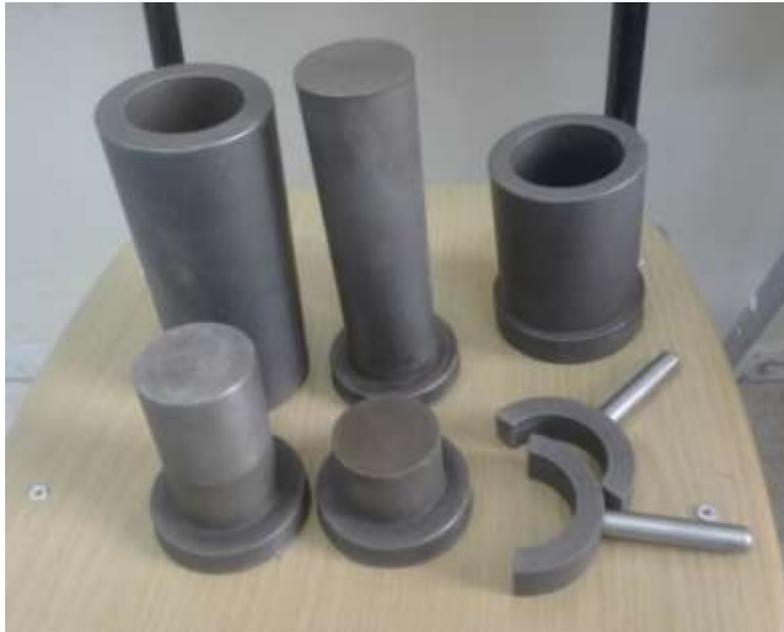
**Photo III- 2:** Moule et pistons des éprouvettes des essais de compression simple.
