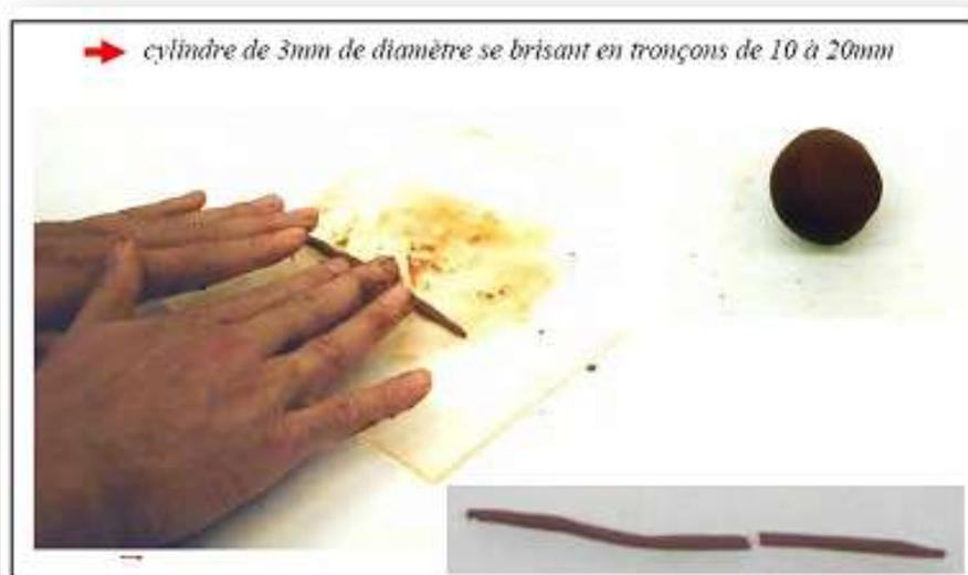
**Figure II- 5 :** Essai de limite de plasticité ;
