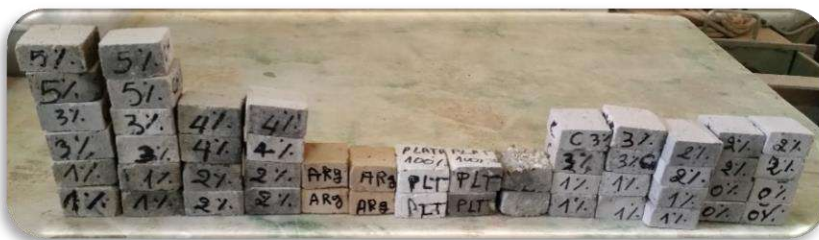
Photo IV.6 : Les échantillon 4x4x2 ciment + la chaux
