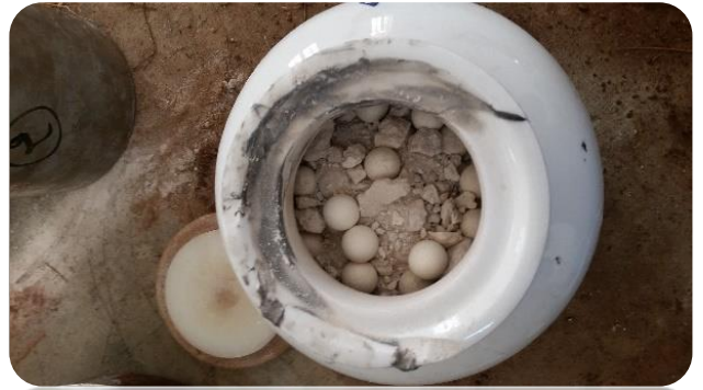
a.2 Broyage de l'échantillon
