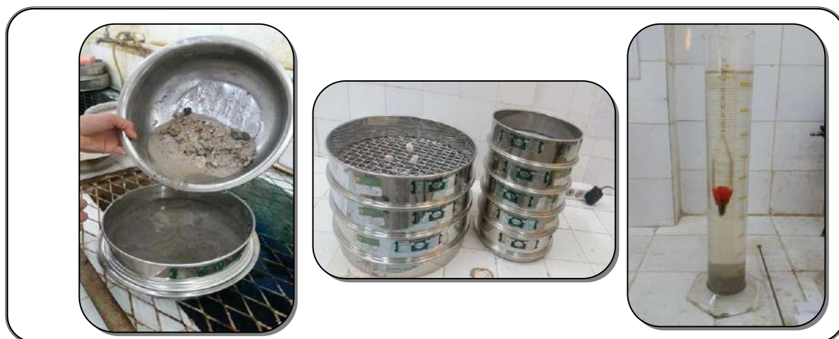
photo (III.4) : Essai analyse granulométrique et Sédimentométrie de Temchemt.
