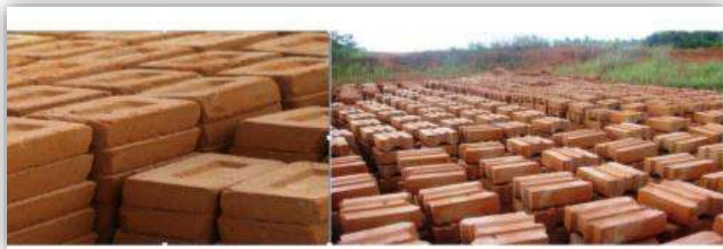
. photo (I.12) : Les Blocs Parasismiques En Terre Crue
