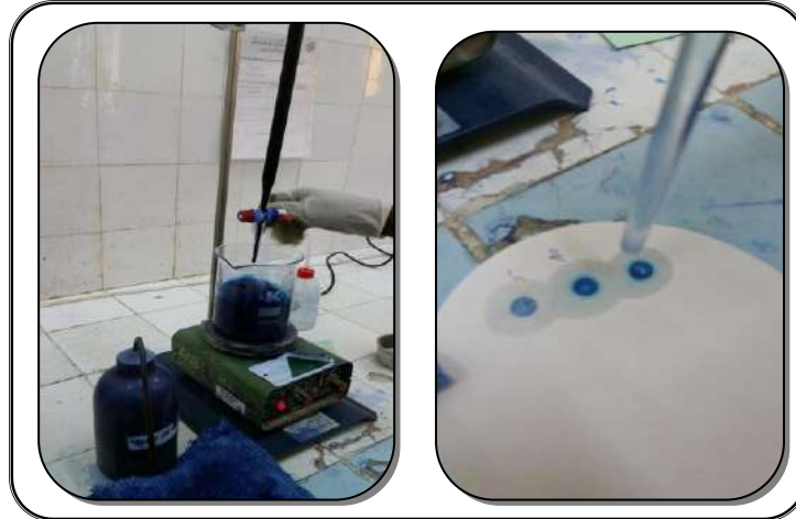
photo (III.7) : Essai de bleu de méthylène
