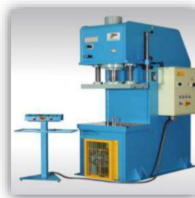
photo (I.10) : une presse manuelle et Hydraulique.
