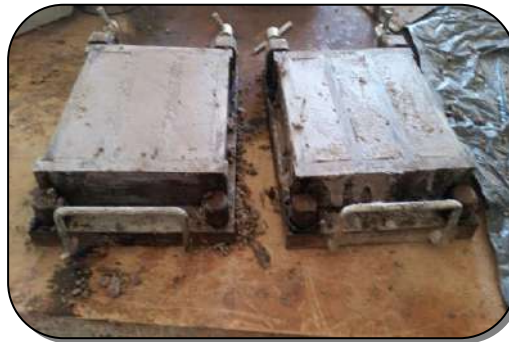
Photo IV.2 : démoulage et séchage des briques
