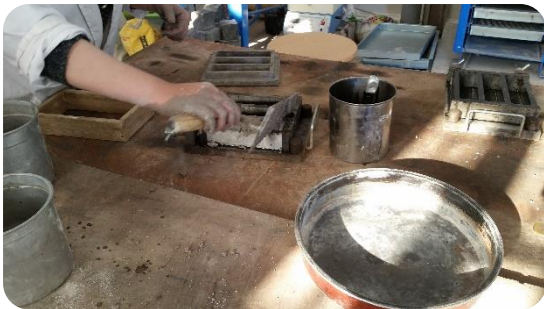
a.3. Coulage de l'échantillon
