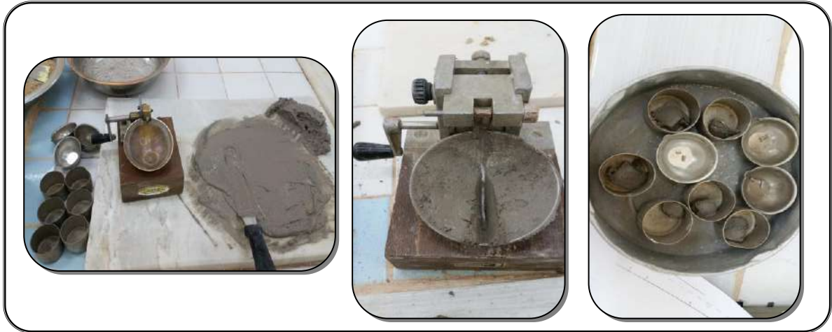
photo (III.5): Manipulation de l'essai de limites d'Atterberg
