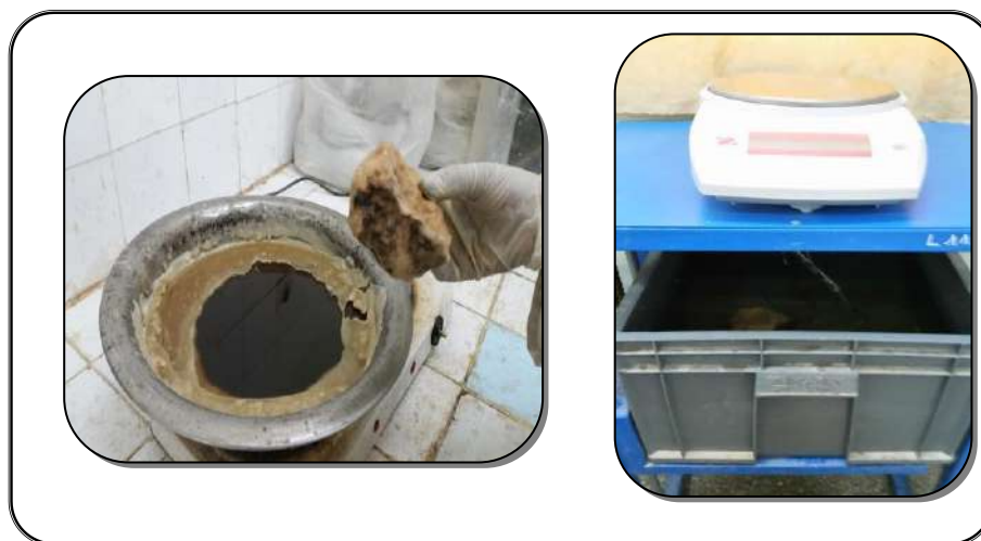
photo (III.3) : Essai densité naturelle
