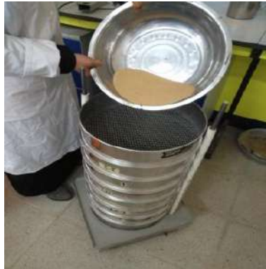
Photo II.4: Essai d'analyse granulométrique.
