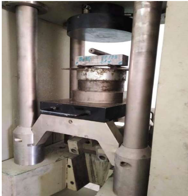
Photos .II.7: Essai de résistance à la flexion (3 points).
