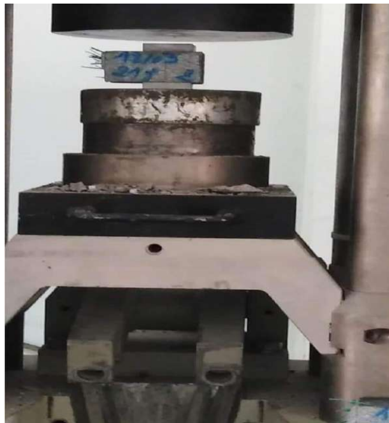
Photo .II.6: Essai de résistance à la compression.
