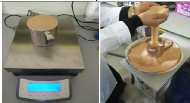
Photo II.2: Essai de la masse volumique apparente
