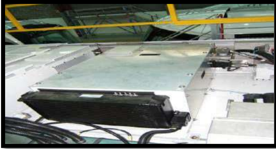
Groupe de refroidissement moteur GRF
