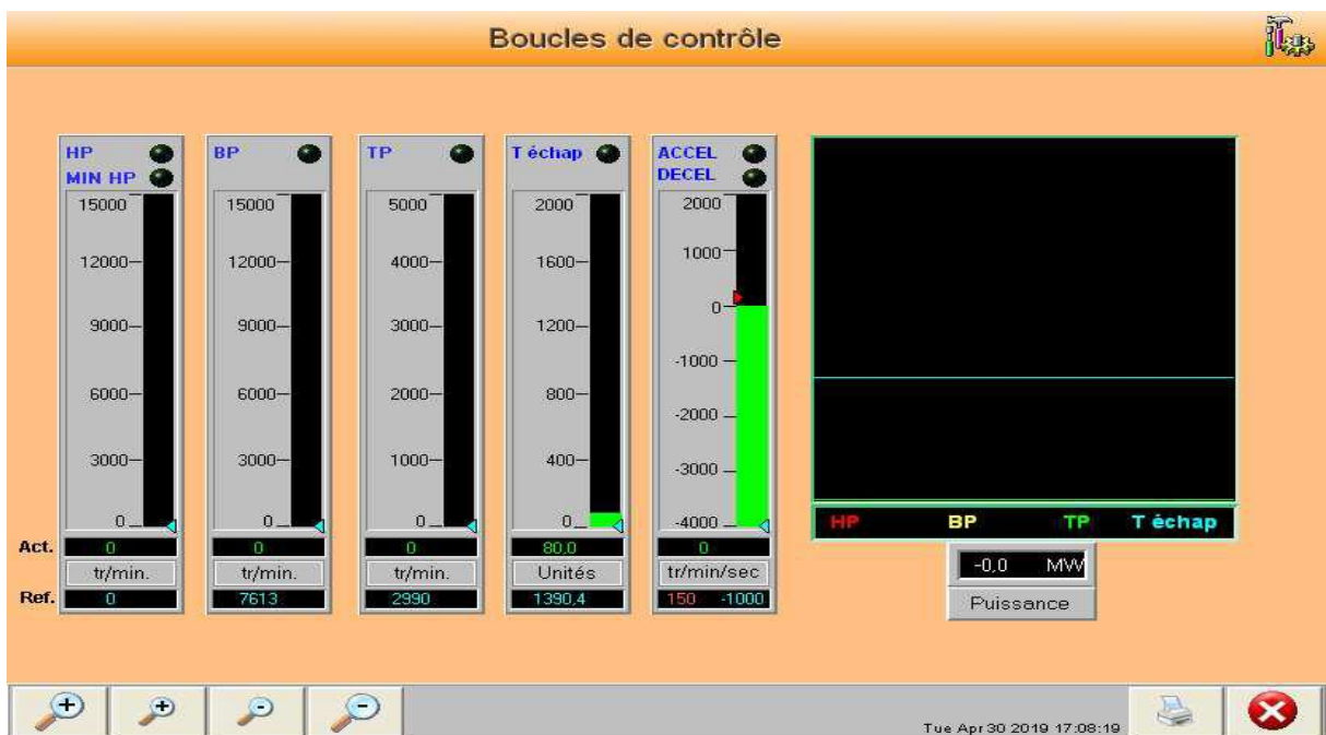
Figure III-6: boucles de régulation turbine
