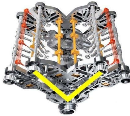
Figure I.17 Moteur en v [3].
