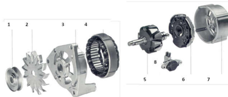
Figure II.16 Les composants d'alternateur [10].
