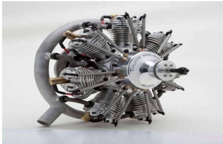
Figure I.20 Moteur radiaux/ en étoile [3].
