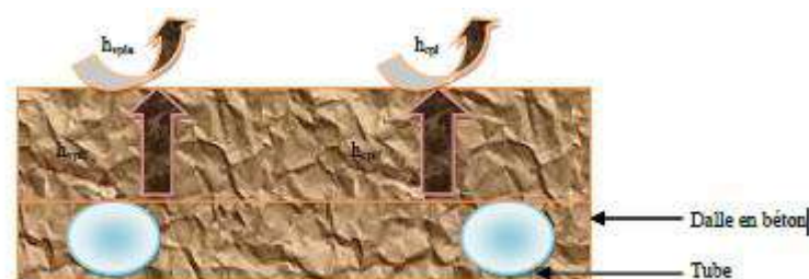
Fig I.5 : Les différents échanges thermiques dans un plancher .
