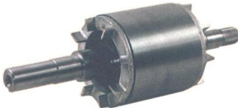
Figure II.9: L'aspect extérieur d'un rotor à cage ne permet pas de distinguer la cage d'écureuil pourtant bien présente à l'intérieur.
