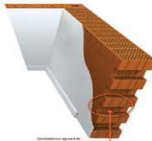
Figure I.2: Isolation répartie des murs. [5]
