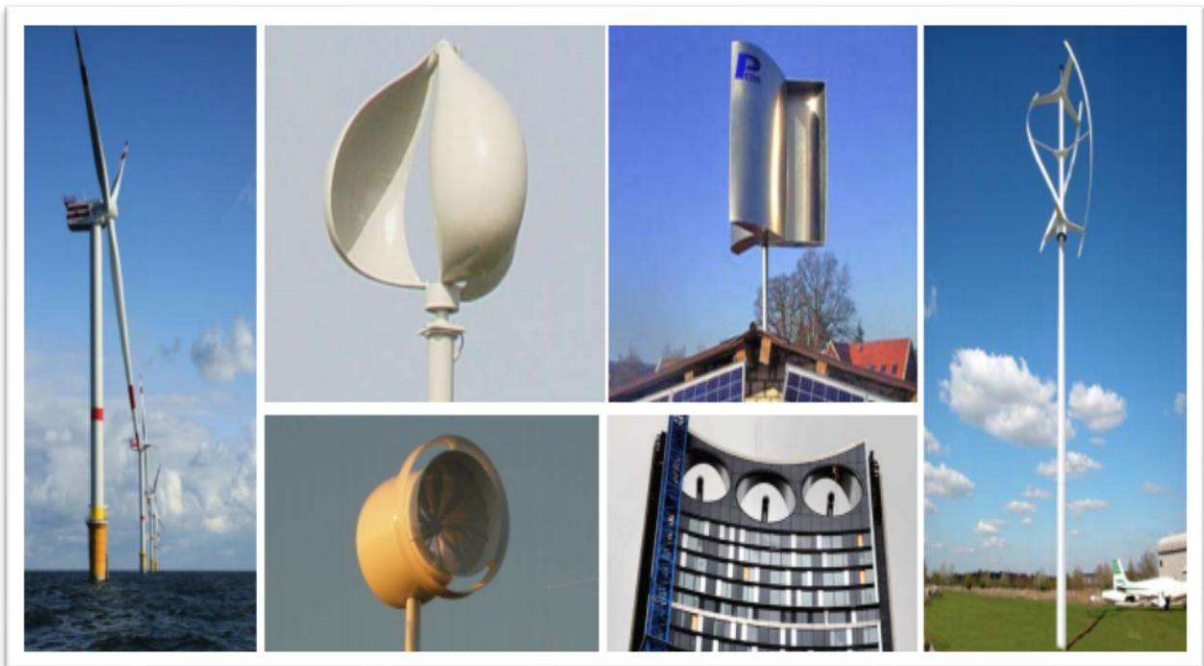
Figure I.3 Eoliennes à axe horizontal (HAWT) ou à axe vertical (VAWT) [9].
