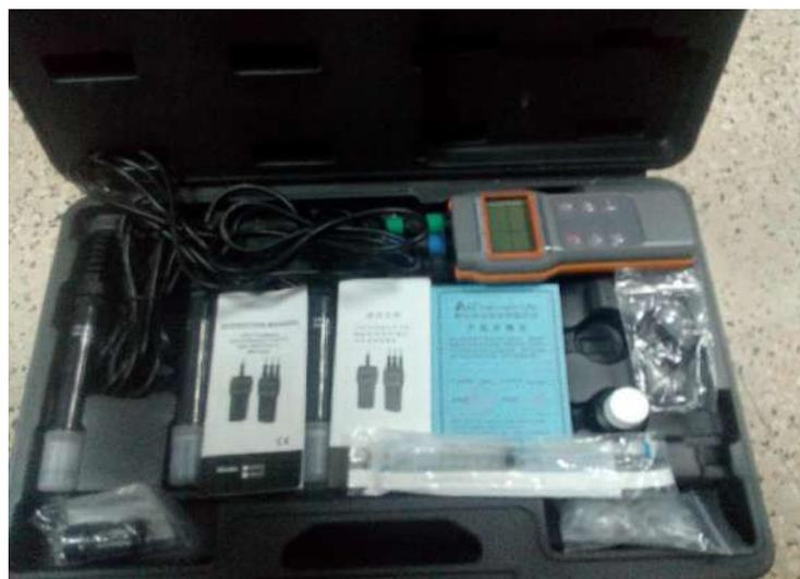
**Figure 5.** Multi paramètre de terrain pour dosage physico-chimique de l'eau
