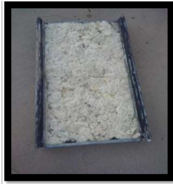
Figure III. 6: le capteur réalise avec laine de mouton
