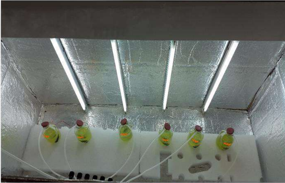
Figure III.7: Le montage expérimental réalisé (culture de Chlorella).
