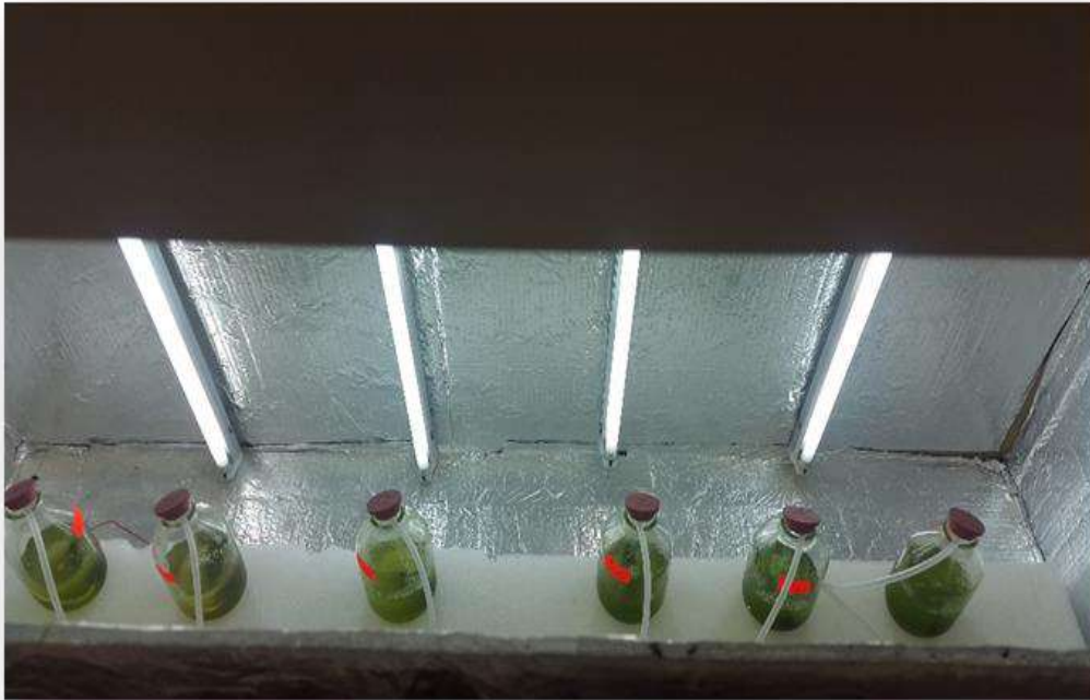
Figure III.8 : Le montage expérimental réalisé (culture de Spiruline).
