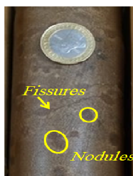
RDC-9 3744m un grés- quartzite fissuré contient des nodules oxydés
