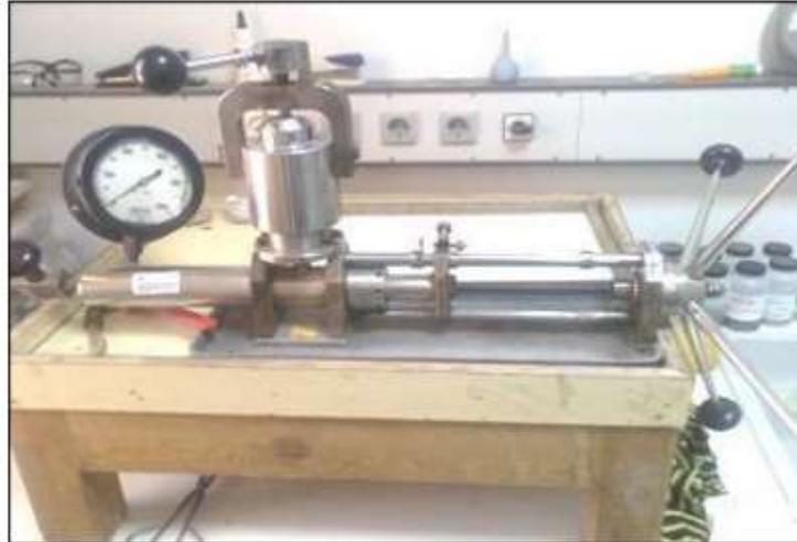
Fig.7 : Pompe de mercure et Micromeritics Autopore III [2]
