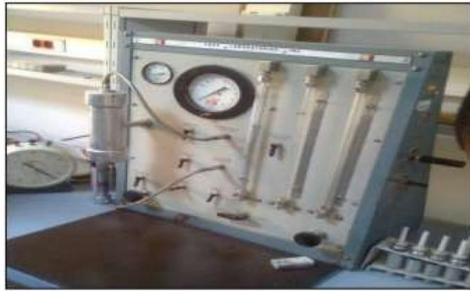
Fig 8 :Perméamètre conventionnel [2]
