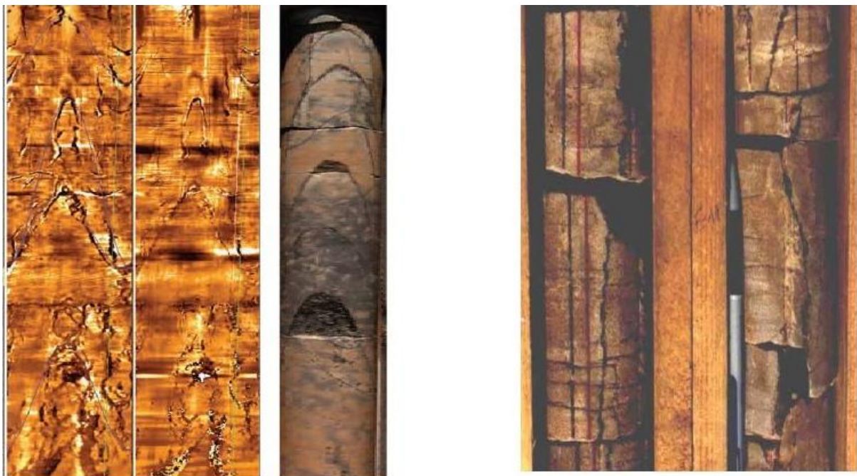
Figure. I.3. Image UBI montrant les Réseau de fracture (QH à HMD)
