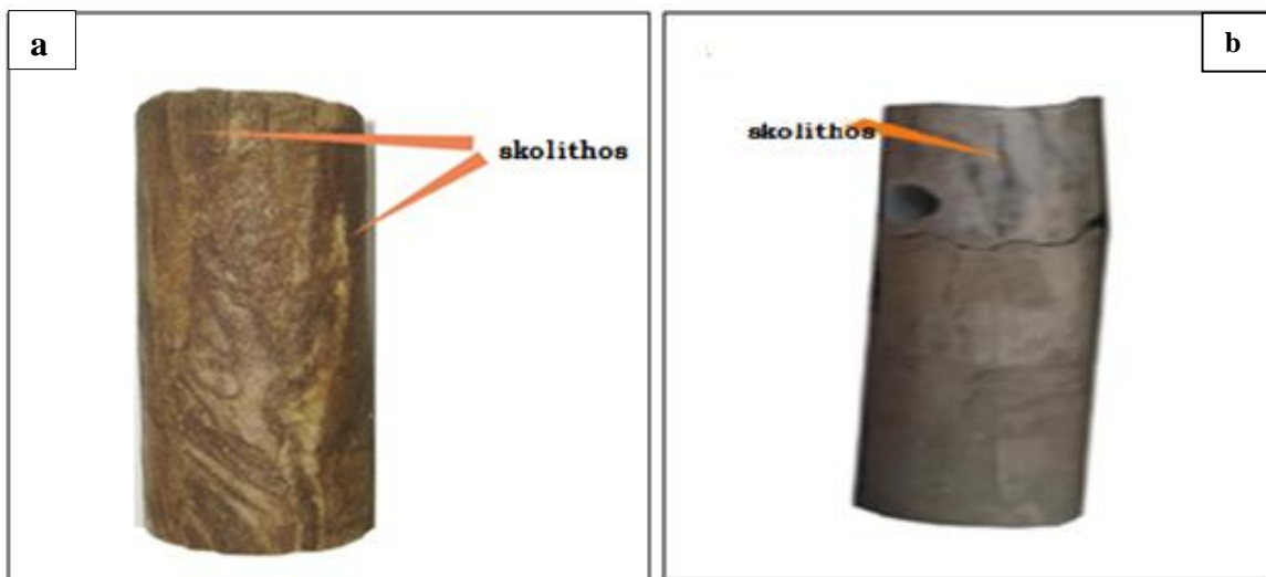
Figure 10 : Aspect macroscopique des intervalles carottes correspondant au faciès Sb: a) puits BRS 12( : 3841.23-3841.45 m (zone 2) ; b) puits BRS: 3852.64-3852.94 m (zone 1)
