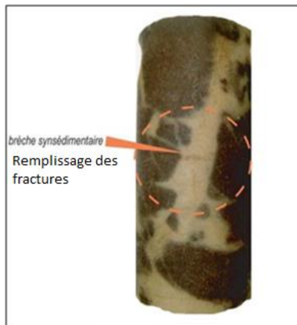
Figure 6 :Aspect macroscopique des intervalles carottes correspondant au facies Sm puit BRS 12 : 3820.00-3820.17m ( zone 1).
