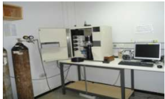
Figure 15. Perméamètre conventionnel (gauche) ; Confining Measurement System - CMS 300 – (droite)[22].
