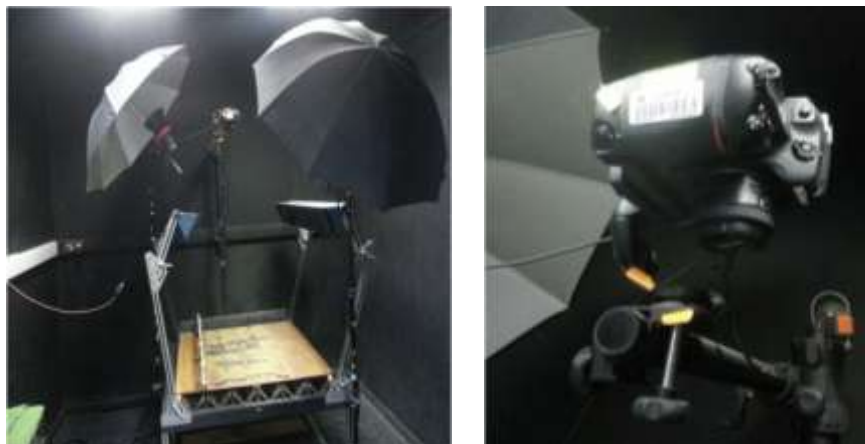
Figure 12. Equipements de photographie type lumière blanche et ultra-violet [24].
