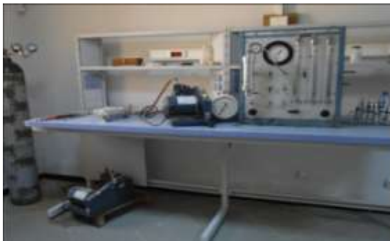
Figure 15. Perméamètre conventionnel (gauche) ; Confining Measurement System - CMS 300 – (droite)[22].
