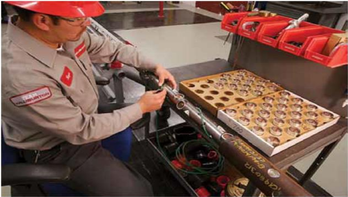
Figure.2.14 : préparation du gun de perforation par l'ingénieur HALLIBURTON.[4]
