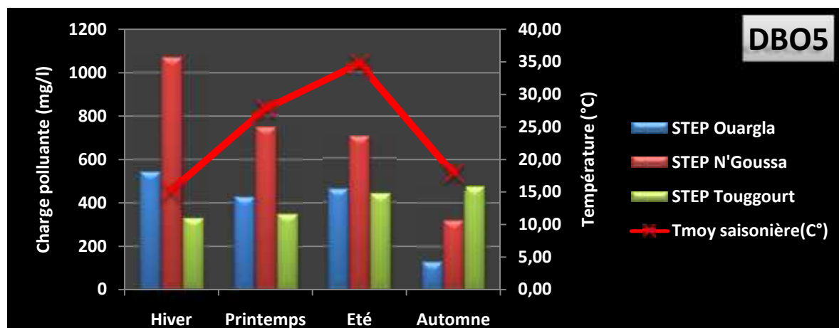
Figure 3- 19: Influence de la température sur la DBO5
