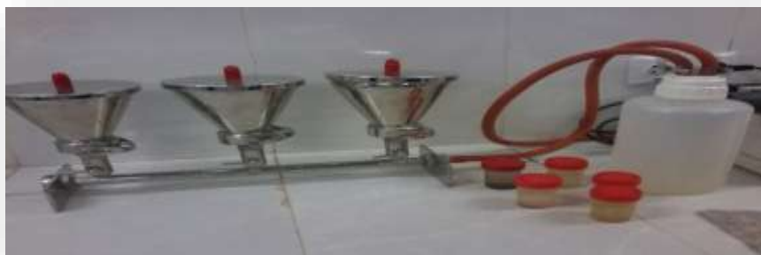
Figure (3) : Unité de filtration avec pompe à vide
