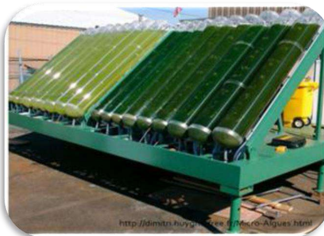
Figure I. 2 : exemple d'un système fermé (bioréacteur) de culture d'algue [5].
