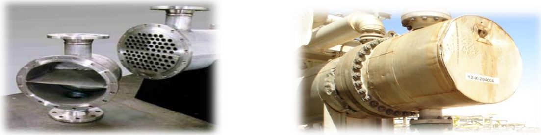
Figure I.13 : Chambre de distribution de type B
