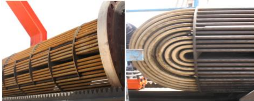
Figure I.15 : faisceau de tube en U
