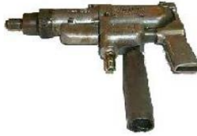
Figure II.4 : Outil de nettoyage mécanique
