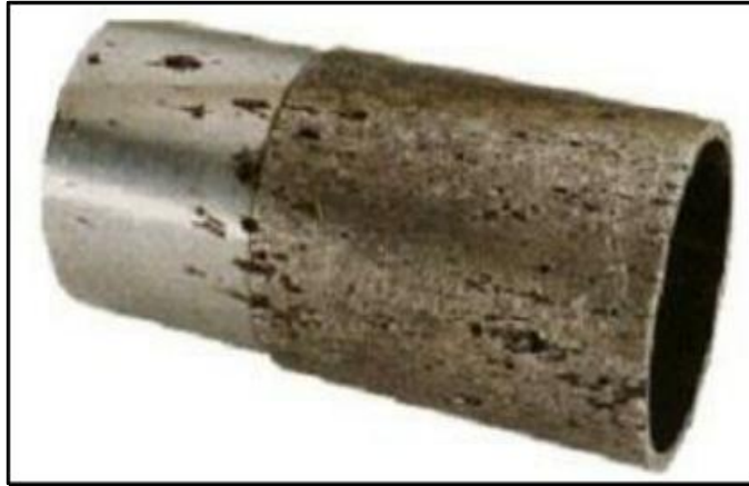
Figure I.3. Corrosion par piqûres.
