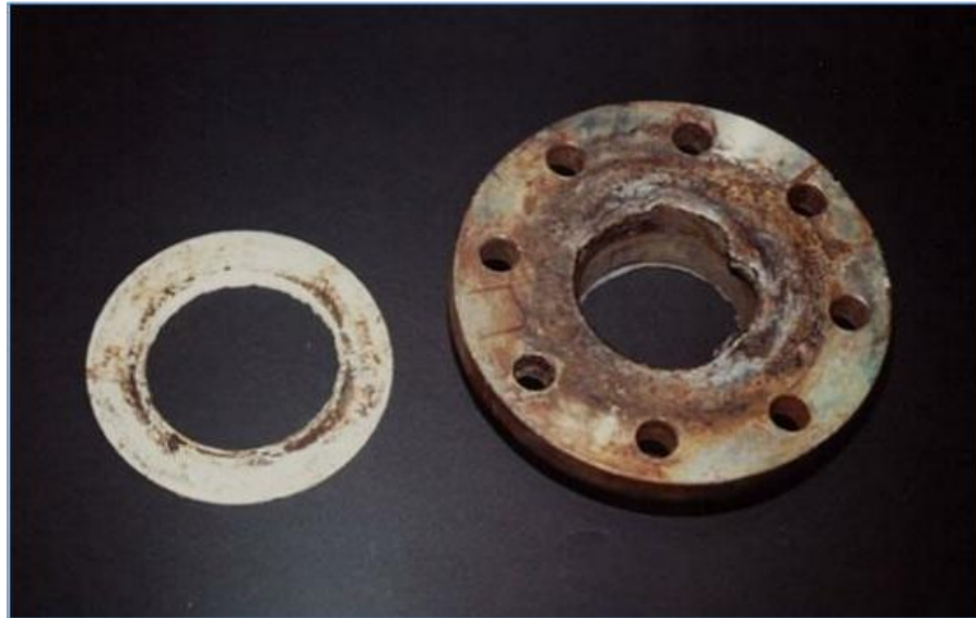
Figure I.8 : Corrosion cavernouse d'un acier allié sous un joint
