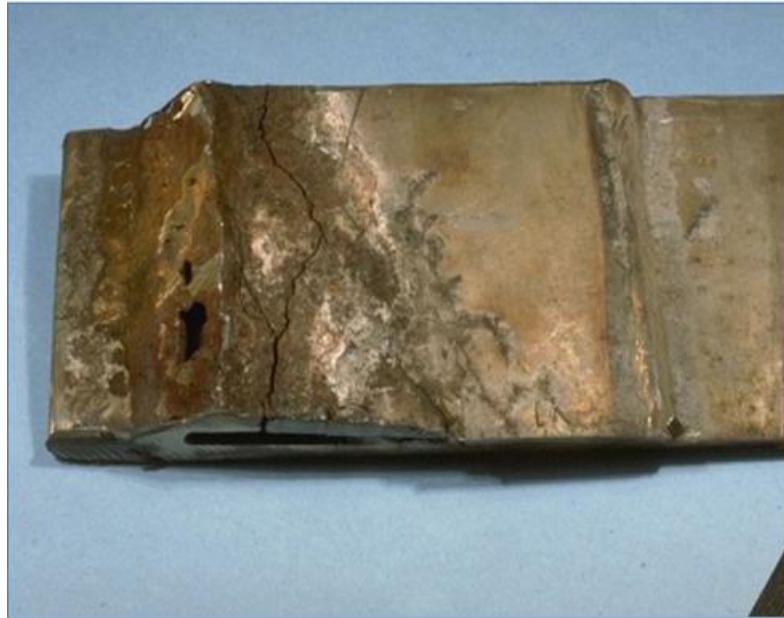
Figure I.7. Corrosion sous contrainte.
