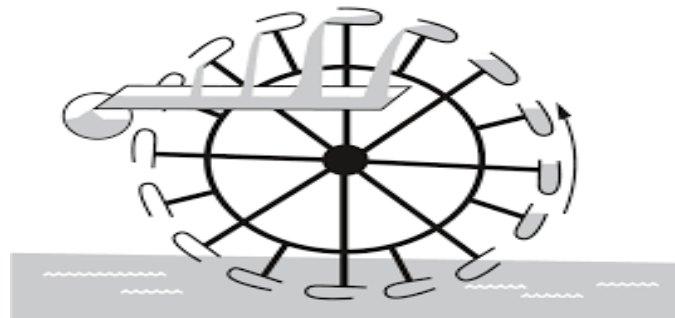
Fig. I.1: Illustration d'une roue à godets chinoise. [1]
