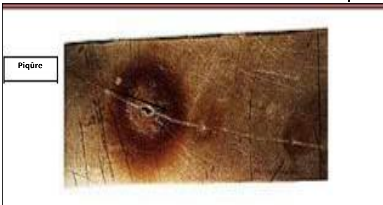
Figure 05 : Corrosion par piqûres d'une cuve en acier inoxydable.
