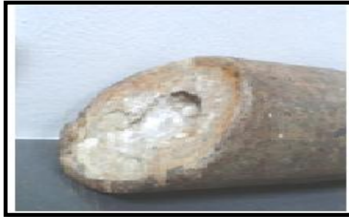
Figure II.7 : Dépôt de sulfate de strontium [1].
