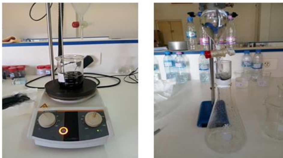
Figure V.10 : Traitement de l'eau d'injection par les nanosphères de carbone.
