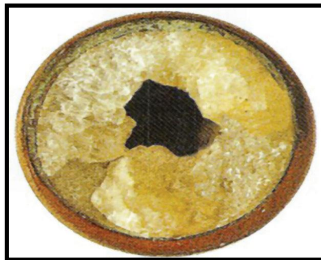
Figure II.4 : Dépôt de chlorure de sodium [1].
