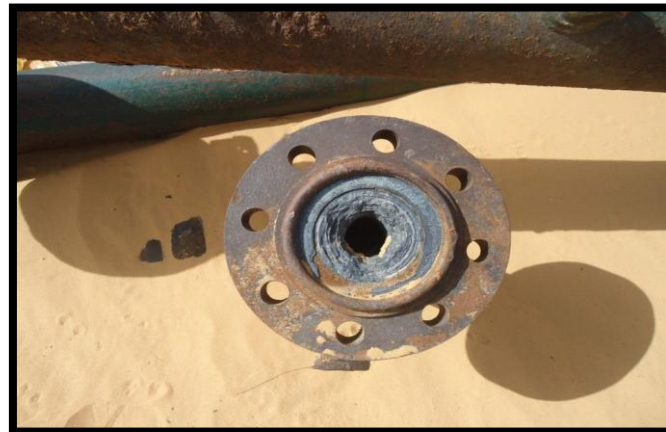
Figure II.8 : Dépôt de sulfate de baryum [1].
