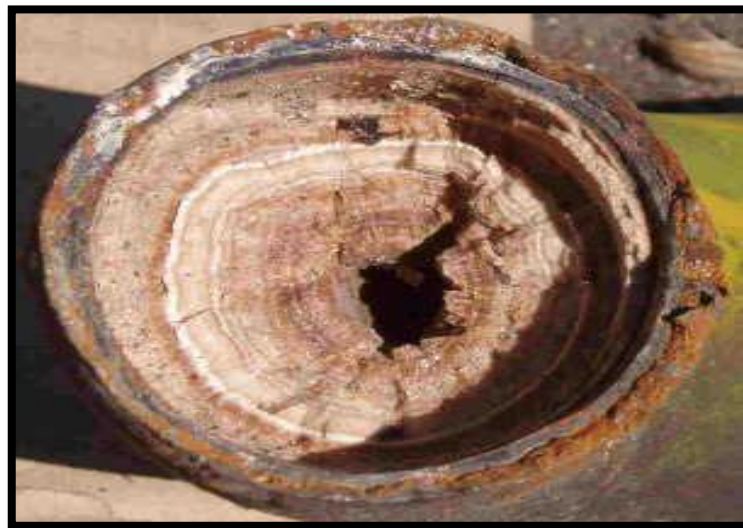
Figure II.5 : Dépôt de carbonate de calcium [12].
