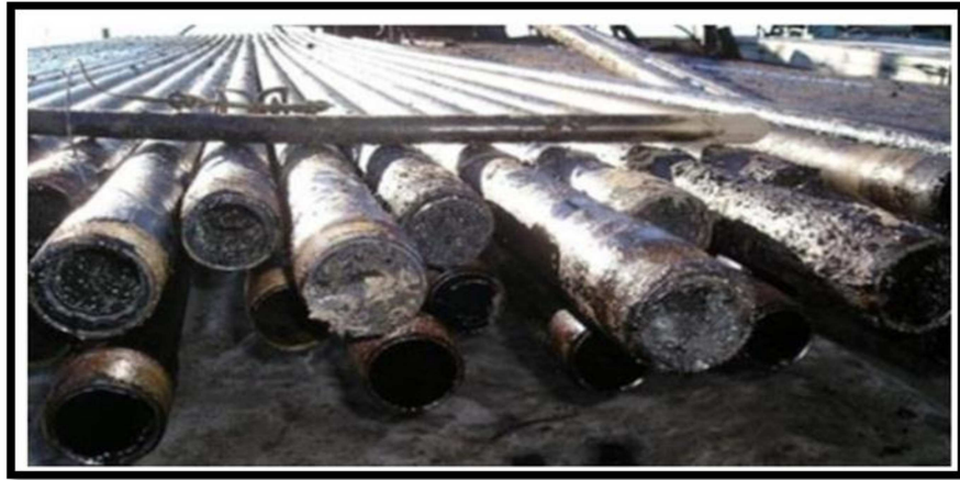
Figure.II.1.Dépôt d'asphaltène dans les tubings de production
