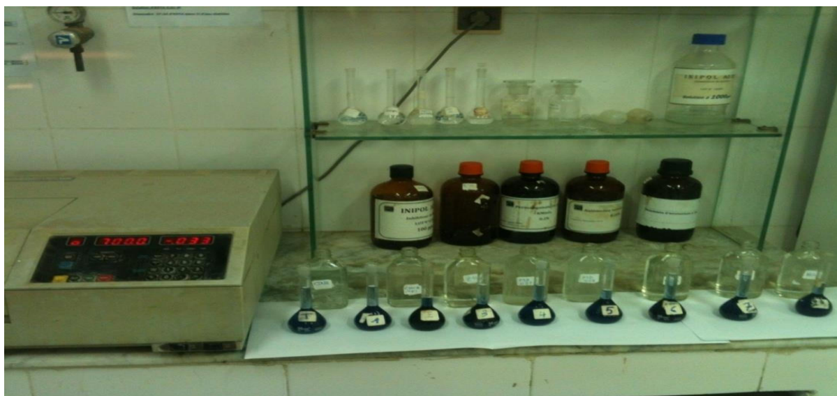
Figure.III.4. Contrôle de la concentration de l'anti-Dépôt par le spectro-photomètre UV-Visible
