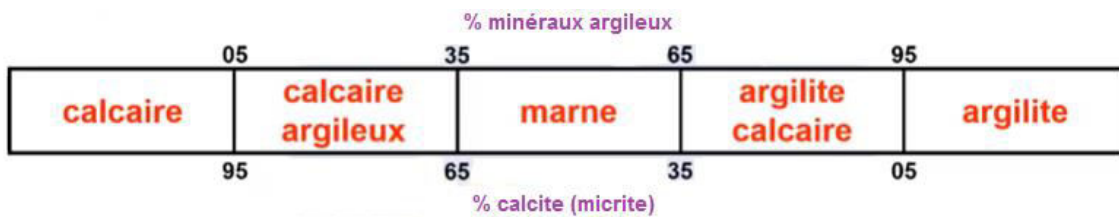
Figure I.3 : Une échelle représente la proportion relative de calcite et de minéraux argileux.[4]
