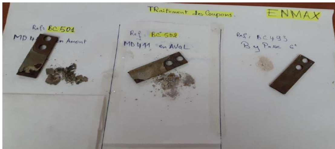
Figure IV.11 : Analyse des coupons de dépôts en amont et en aval d' ENMAX.
