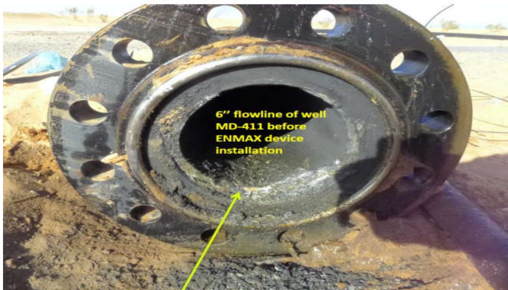
Figure IV.13 :formation de dépôts avant l'installation d'ENMAX .
