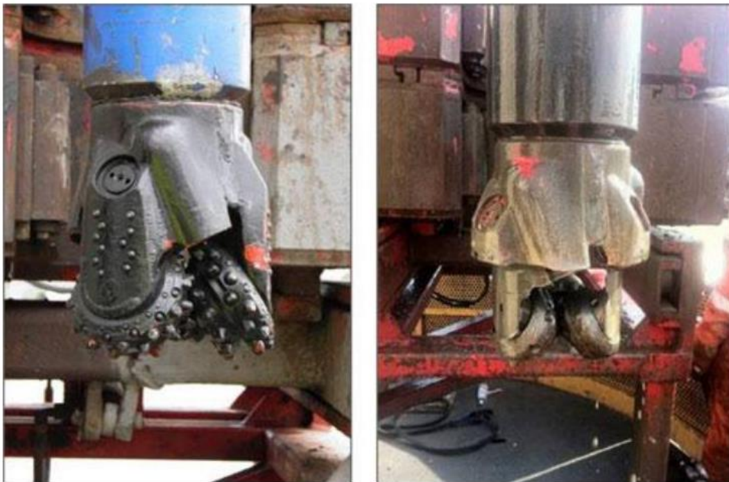
Figure I-8: l'outil après l'endommagement
