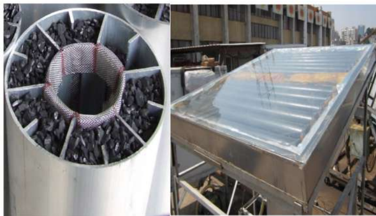
Figure.I.32 : Schéma de tube d'ailette et collecter de la machine [11].
