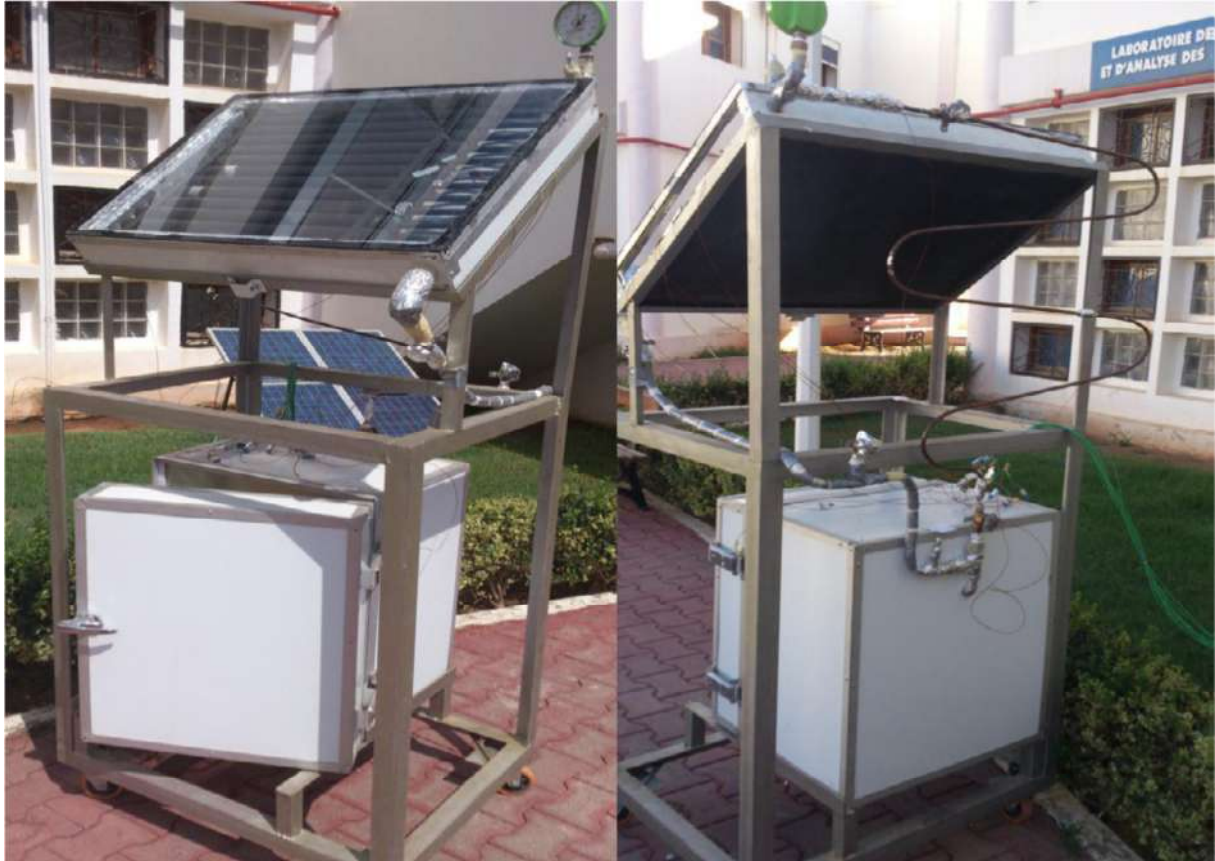
Figure.I.20: Photo d'une machine solaire à adsorption [99].
