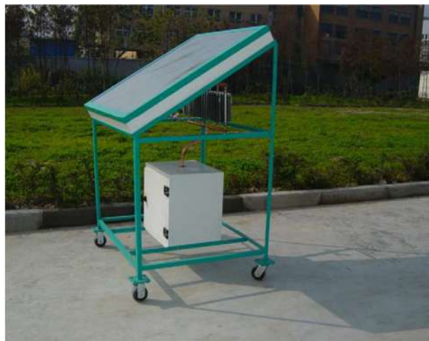
Figure.I.26 : Photo de la machine solaire à adsorption sans vannes [114].
