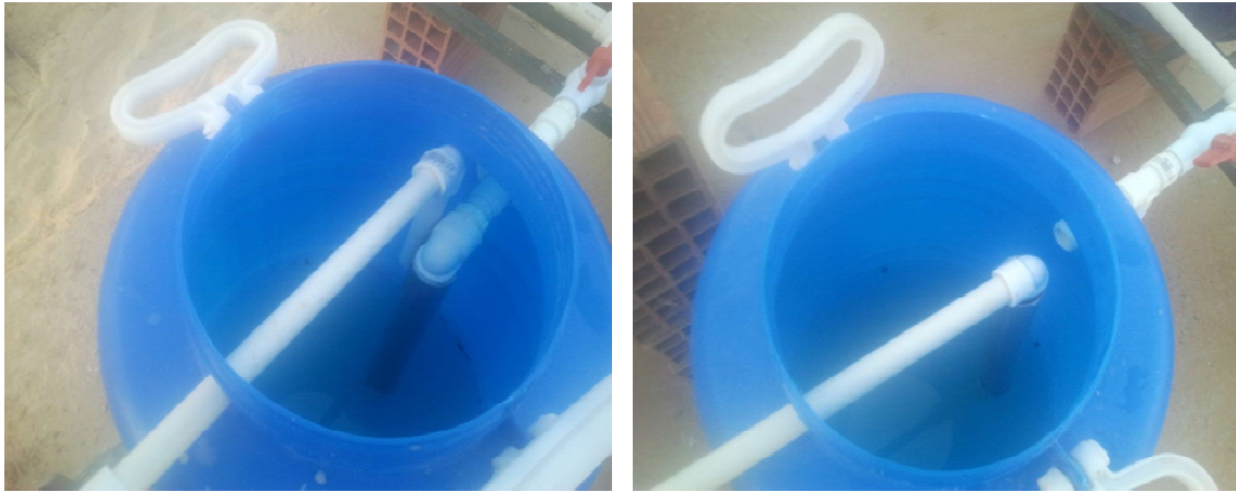
Figure 14 : Types d'écoulement d'eau usée dans les biofiltres, (a gauche : flux descendant, a droite : flux ascendant).
