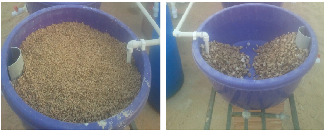
Figure 15: Type du substrat utilisé dans la filtration des eaux usées
