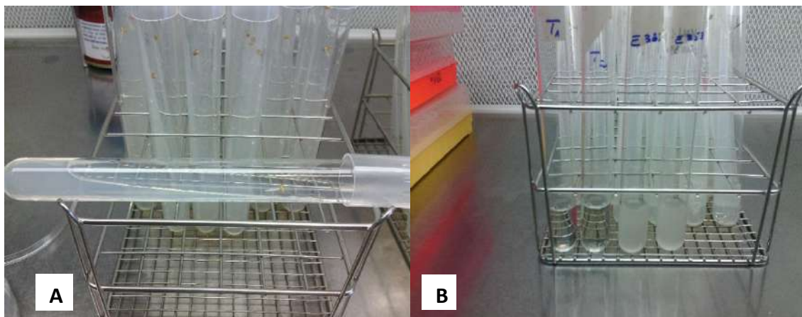
Photo 3: Quelques étapes de mise en place du test d'authentification : A) graine germée dans un tube Gibson ; B) préparation des inoculum bactériens dans des tubes à essais.
